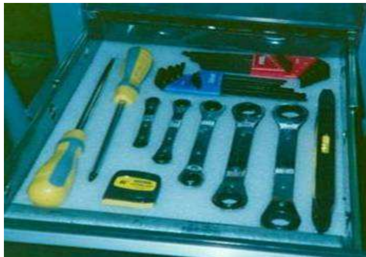
รูปที่ 2.3 ตัวอย่างการเตรียมเครื่องมือ แม่พิมพ์ให้พร้อมใช้งานด้วย Setup Cart
